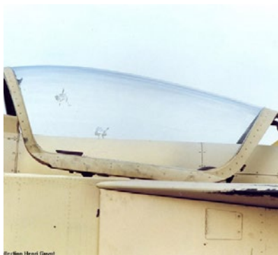
Trous d'entrée et de sortie de la balle de Kalashnikov sur la verrière et le casque de Charly
