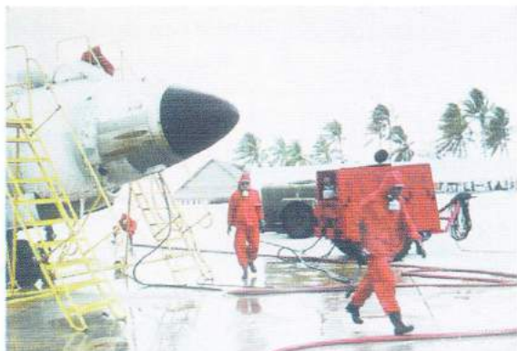
Décontamination d'un avion Vautour à l'aide du groupe moto-pompe « Eau chaude-vapeur ».
