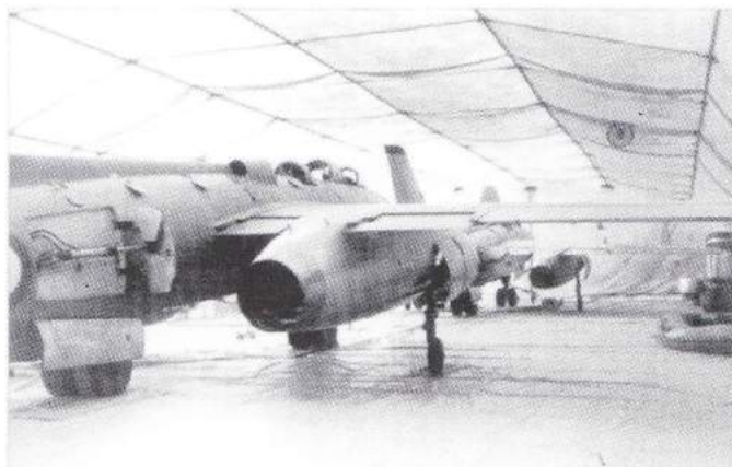
Stockage des VAUTOUR sous tente anhydre
